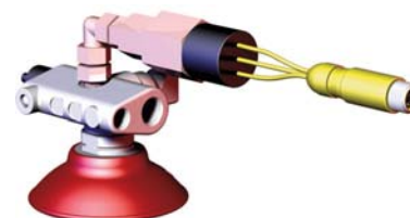
„Flache Serie“ 750 mit Abblasanschluß, Vakuumschalter und Schalldämpfer CPI-VSA-750-BO-LP-VSS-ST2
